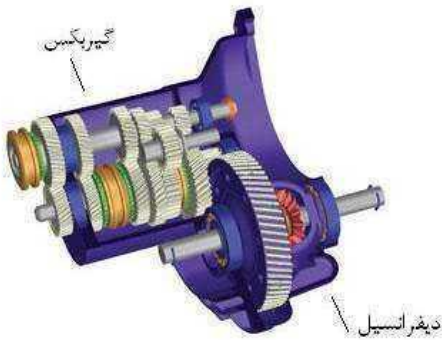
مجموعه گیربکس و دیفرانسیل در یک خودروی دیفرانسیل جلو
