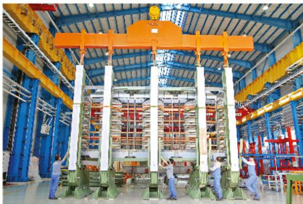
هسته ترانسفورماتور از ورق‌های فولاد سیلیکونی جهت دار کم تلفات با ضخامت‌های مختلف از  $0.22/0.23$  میلی‌متر ساخته می‌شوند. ورق‌ها به شکل رول از سازندگان معترض تامین و در سایزهای مختلف توسط دستگاه‌های پیشرفت‌به دقت بریده شده، به طوری‌که در لبه‌های برش خورده، آشفتگی میدان‌های مغناطیسی و تلفات به حداقل برسد.
