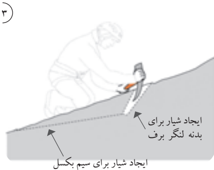
از کلنگ و لنگر برای تعیین زاویه نصب استفاده کنید.
