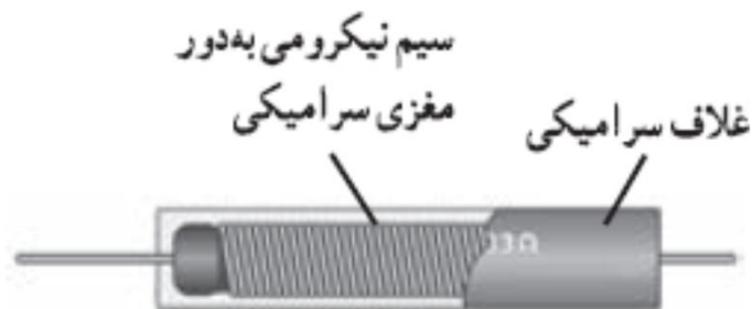
الف) نمونه‌ای از ساختار یک مقاومت پیچه‌ای
