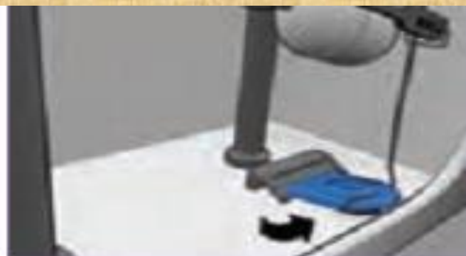
ج - اطمینان از نبودن زنجیر یا هر شیء خارجی در زیر دربوش تخلیه
