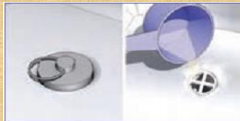
ب - افزودن سرکه و گذاشتن در بوش زیر آب
