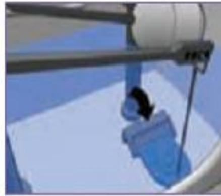
ب - اطمینان از بسته بودن کامل درپوش لاستیکی و اتصال زنجیر به آن
