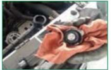
ت - در رادیاتور را به آرامی از محل خود بردارید.
