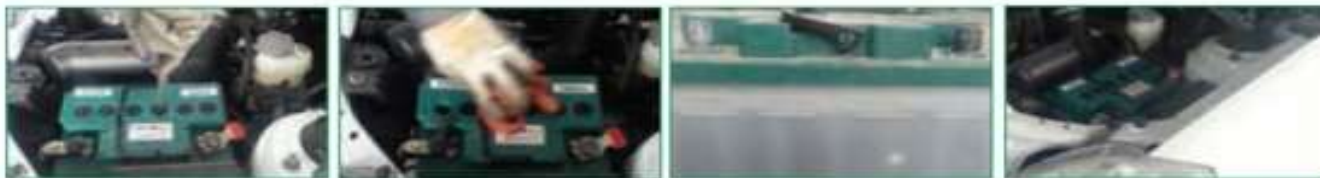
الف - محل باتری خودرو را مشخص کنید. ب - به سطح مایع باتری، با توجه به شاخص‌ها، توجه کنید. ب - در صورت کم بودن سطح مایع باتری، با بارچه تمیز سطح آن را تمیز کنید. ت - در پوش خانه‌های باتری را باز کنید.
