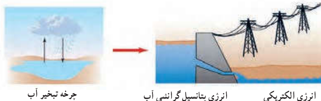
شکل ۱۲- انرژی پتانسیل گرانشی آب پشت سد توسط توربین ها و میدل ها به انرژی الکتریکی تبدیل می شود.
