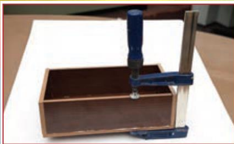
شکل ۱۶-۷- بستن جعبه به وسیله پیچ دستی
