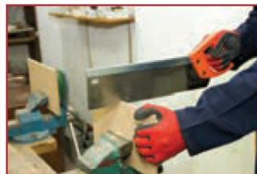
الف - بریدن قطعات با اره ظریف بر
