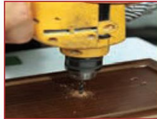
پ - سوراخ کردن در جعبه با دریل
