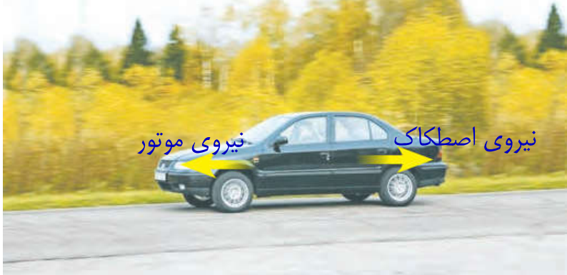
شکل ۳ - وقتی نیروهای وارد بر خودروی در حال حرکت متوازن باشند، خودرو با سرعت ثابت حرکت می کند. (شتاب صفر)
