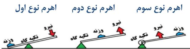
**در حالت اول** تکیه گاه و سطح نیروی مقاوم و محرك قرار دارد و بازوی مقاوم باشد. این نوع اهرم در سه حالت مورد استفاده قرار می‌گیرد. مکانیکی برابر یک است. وسایلی که در آنها این نوع اهرم قرار دارد با تغییر جهت نیرو به ما کمک می‌کنند.
