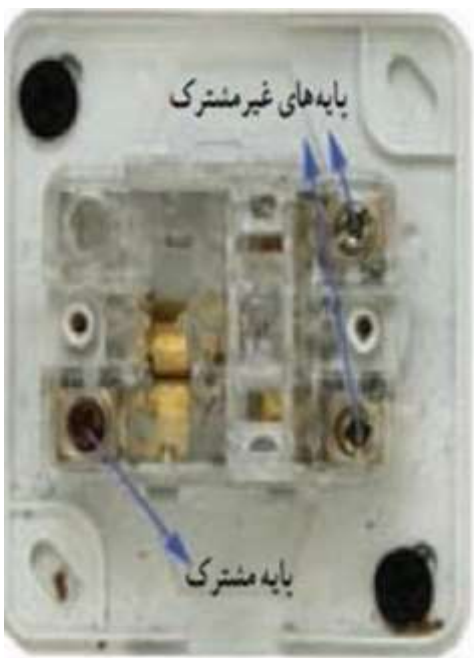
شکل ۱۹-۵- نمای داخلی یک نمونه کلید تبدیل
