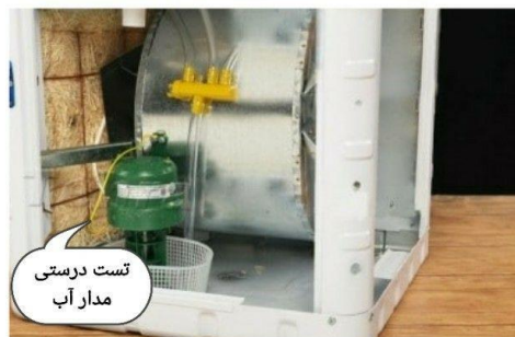
بررسی و تمیز کردن پمپ آب
