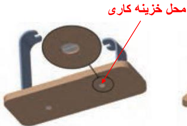
قرار گرفتن گل پیچ با قطر ۸ میلی متر
