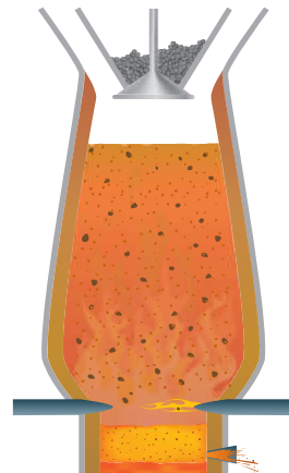
۲ (ب) گرما دادن مخلوط سنگ آهن، کربن و سنگ آهک تغییر شیمیایی
