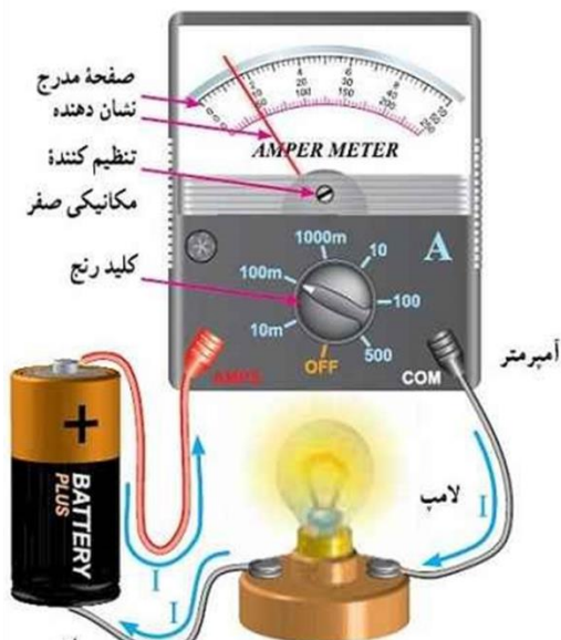
نحوه قرار گرفتن آمپر متر در مدار
