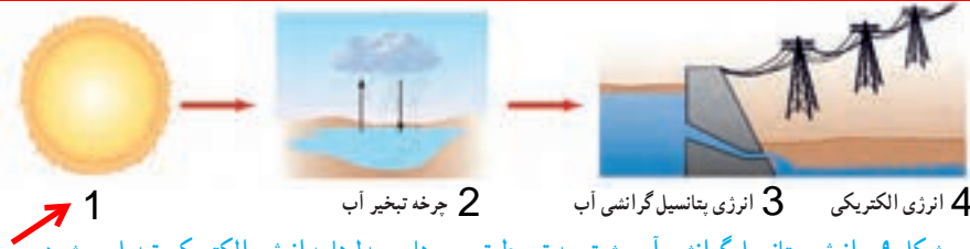
شکل ۹- انرژی پتانسیل گرانشی آب پشت سد توسط توربین‌ها و مبدل‌ها به انرژی الکتریکی تبدیل می‌شود.
