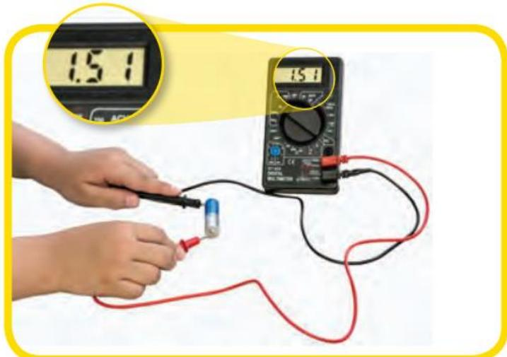
شکل ۶. اندازه گیری اختلاف پتانسیل دو سر باتری
