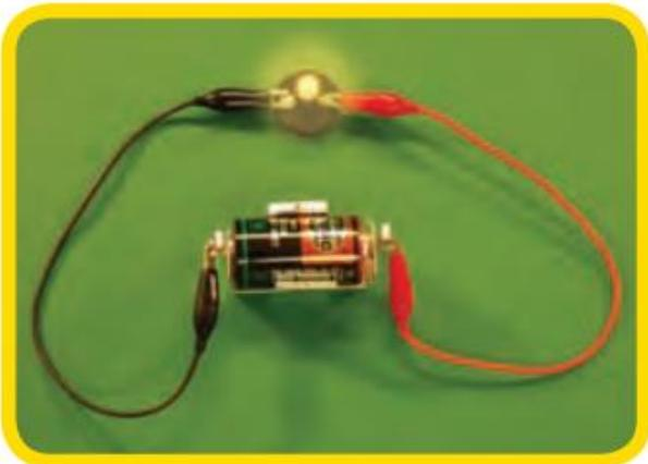
شکل ۵- مدار الکتریکی ساده
