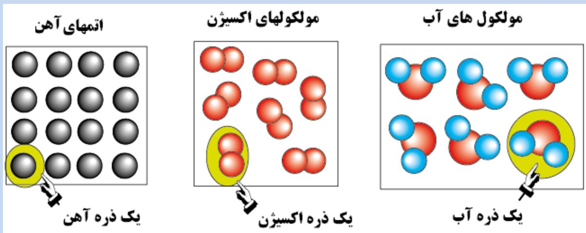
همانطور که در تصاویر بالا می‌بینید (تصویر سمت چپ) در یک تکه آهن اتمهای آهن به صورت جدا و مستقل دیده می‌شوند به همین دلیل می‌گوییم اتم آهن کوچکترین ذره آهن است.
