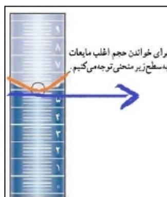
از استوانه مدرج برای اندازه گیری حجم مایع استفاده می شود.
