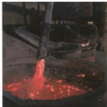
شکل ۱۸- فرایند هال برای تولید آلومینیوم از \text{Al}_2\text{O}_3
