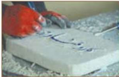
شکل ۷-۲۳- کنده کاری قطعه گچی
