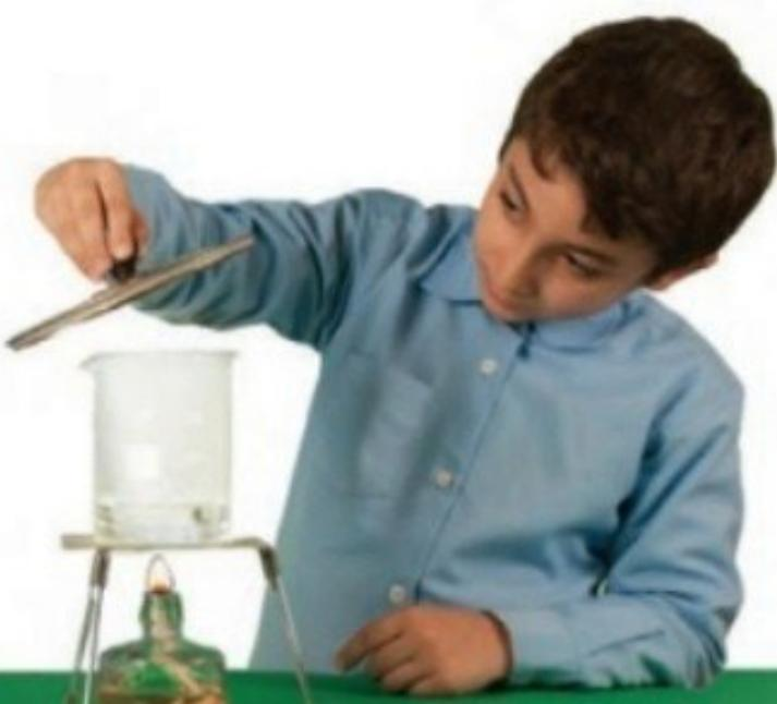
در این آزمایش، آب پس از داغ شدن از حالت مایع به حالت گاز تبدیل می‌شود. بخار آب داغ که به در سرد قابلیه برخورد می‌کند، دوباره به قطره‌های آب تبدیل می‌شود.
