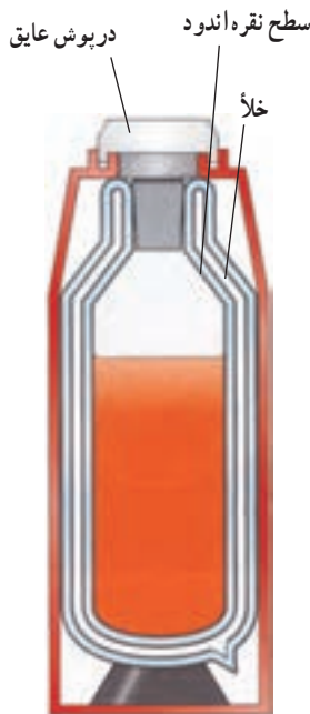
شکل ۱۳- دمابان (فلاسک) خلا می تواند مدت نسبتاً زیادی دمای جسم را تقریباً ثابت نگه دارد.
