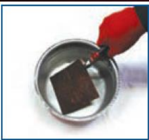
شکل ۹-۱۰- سرد کردن پلاک مسی با آب
