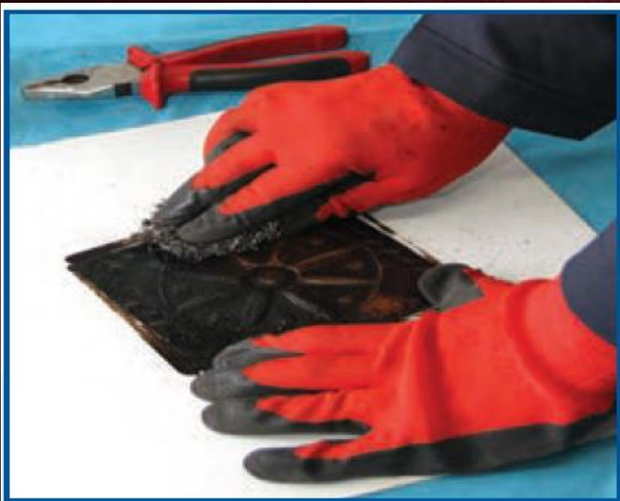
شکل ۱۱-۱۰- ساب زدن سطح بلاک مسی
