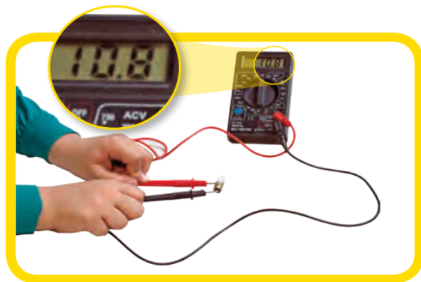
شکل ۸- اندازه‌گیری مقاومت لامپ خاموش با اهم‌سنج
