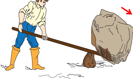
شکل ۴ - مرد با وارد کردن نیروی کوچکی بر دسته اهرم می تواند جسم سنگینی را بلند کند.
