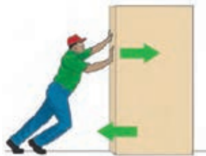
شکل ۲ - شخصی به جعبه ساکن نیرو وارد می‌کند ولی جعبه حرکت نمی‌کند؛ زیرا نیروی روبرو به جلو با نیروی اصطکاک رو به عقب هم‌اندازه‌اند.
