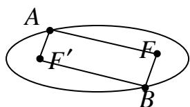
نقطه  $B$  روی بیضی قرار دارد، بنا به تعریف بیضی  $BF + BF' = 2a$
