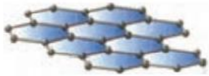
مدل گلوله و میله برای نمایش گرافن.
