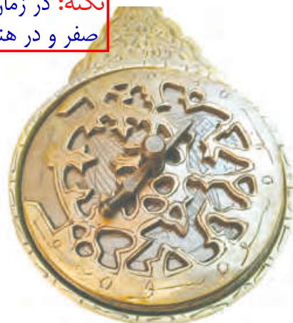
شکل ۱- الف) اسطرلاب، ب) نحوه رصد ستاره به وسیله اسطرلاب
