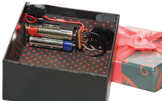
شکل ۲۸-۲- جانمایی مدار پروژه و کلید
