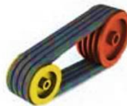
ب- ساز و کار حرکتی چرخ تسمه
