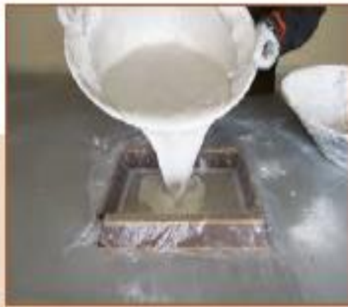
ث - ریختن ملات گچ در قالب
