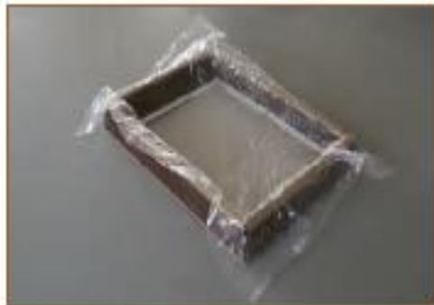
ب - قراردادن نایلون در قالب شکل ۲۰-۷ - تهیه قالب
