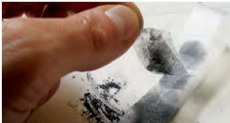
شکل ۴- تهیه گرافن با استفاده از نوار چسب
