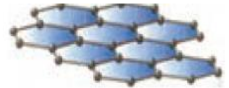
شکل ۳- مدل گلوله و میله برای نمایش گرافن.
